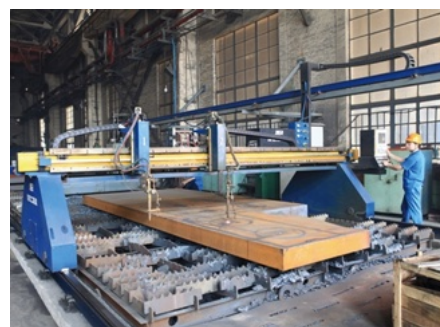
NC プラズマフレーム切断機
